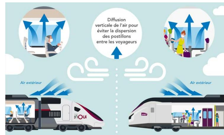
Figure 1: Figure de la SNCF montrant la circulation de l'air dans les TGV et les autres trains
