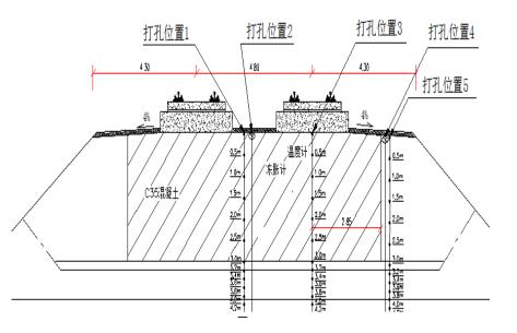
研发了高速铁路路基粗粒填料冻胀试验方法及装置,提出了基于不利条件填料冻胀率的基床冻胀计 算方法,创新了高渗透性、低持水性、弱冻胀性填料路基和特殊条件下混凝土基床等防冻胀路基结构, 解决了严寒地区路基防冻胀世界性难题。
